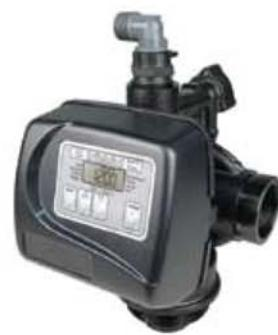
• Válvula S200L: funcionamento automático. Construída em bronze. O controlo das etapas realiza-se através de um pistão horizontal. Diferentes programadores disponíveis. As válvulas volumétricas incorporam um contador de água tratada equipado com emissor de impulsos.
