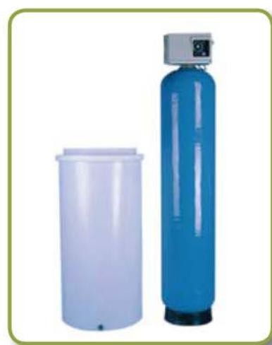
● Válvula 2750: Funcionamento automático, corpo construído em bronze. O controlo das etapas realiza-se através de um pistão lateral. Incorpora um programador electromecânico que permite ajustar a duração das diferentes etapas da regeneração. As válvulas volumétricas incorporam um contador de 40m<sup>3</sup> até 250 litros de resina. Para volumes maiores vão equipadas com contador estendido de 100 m<sup>3</sup>.
