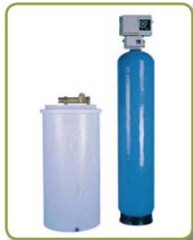
● Válvula 2900: Funcionamento automático, corpo construído em bronze. O controlo das etapas realiza-se através de dois pistões laterais. Incorpora um programador electromecânico que permite ajustar a duração das diferentes etapas da regeneração.
