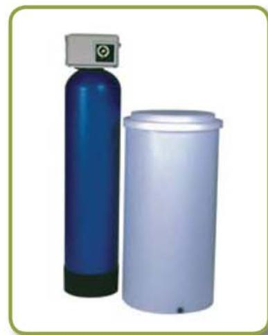
• Válvula 2850: Funcionamento automático, corpo construído em bronze. O controlo das etapas realiza-se através de um pistão lateral. Incorpora um programador electromecânico que permite ajustar a duração das diferentes etapas da regeneração. As válvulas volumétricas incorporam um contador de 40m<sup>3</sup> até 250 litros de resina. Para volumes maiores vão equipadas com contador estendido de 200 m<sup>3</sup>.
